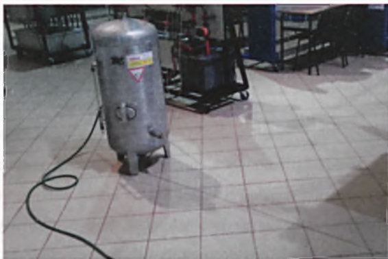
Fot. 3.3. Zbiornik hydroforowy z podłączonym przewodem silikonowym wykorzystany w badaniach.
