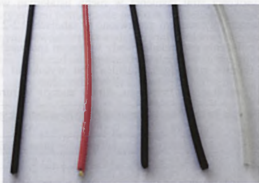
Fot. 2.5. Przewody umieszczane w rurociągu wykorzystane w badaniach hydraulicznych.
