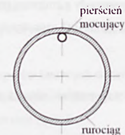
Rys. 2.9. Schemat umiejscowienia pierścieni mocujących w rurociągu.
