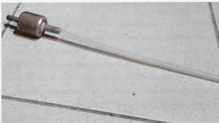
Fot. 3.4. Końcówka przewodu silikonowego, do której podłączono czujnik ciśnienia.
