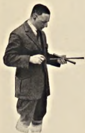
Rys. 29. Wydobywanie wkręconego walca drzewa, obrazującego wewnętrzną stan badanego słupa.
