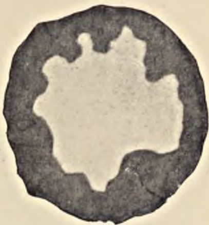
Rys. 19. Obraz dyfuzji soli fluorowej w 4 miesiące po zaimpregnowaniu drzewa metodą Kobra
