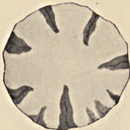
Rys. 20. Obraz dyfuzji soli fenolowej w 4 miesiące po zaimpregnowaniu drzewa metodą Kobra
