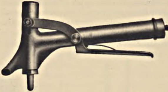
Rys. 30. Ręczna maszynka, tak zwany pistolet, służąca do impregnowania słupów metodą Kobra, nawet po ustawieniu ich na gruncie.
