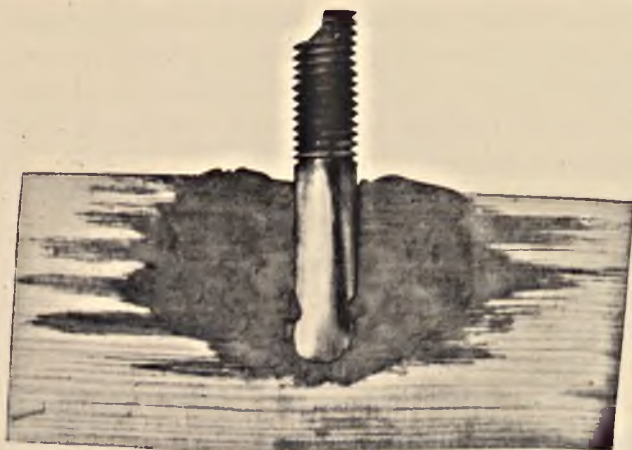
Rys. 16. Zastrzykiwanie środka impregnacyjnego za pomocą igły patentu Kobra.
