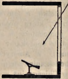
Rys. 13. Wadliwe oświetlenie dzienne przy „pawilonie szklanym”, oraz przy użyciu jedynie szyby przedniej (według Hellera ).
