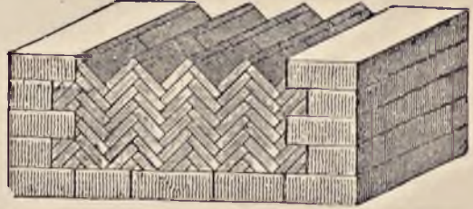
Rys. 16. Wiązanie polskie w jedlinkę czyli w okłos w murach rzymskich, zwane „opus spicatum”. (H. Otte).
