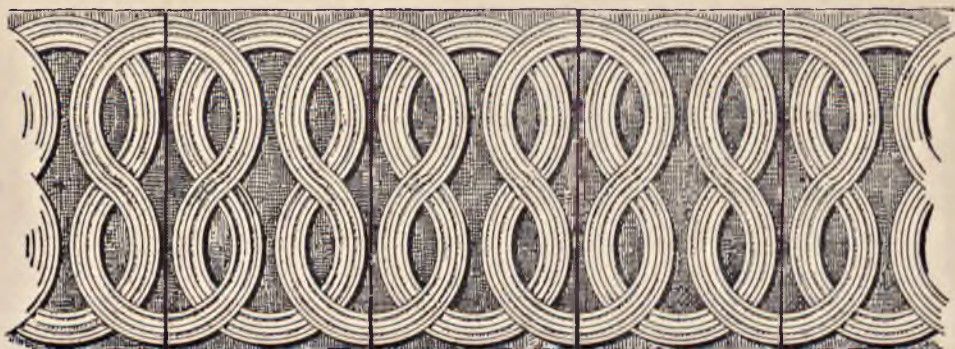
Rys. 9. Pas z cegieł ułożony, o wstędze przeplatanej na wzór ogniw łańcuchowych. (Kościół św. Jakóba w Sandomierzu).
