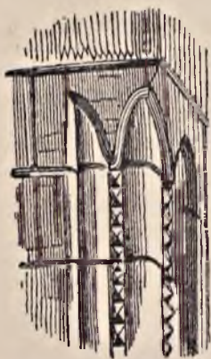
Rys. 27. Słupek węglowy z cegły wykonany z odrzwi Ade- lajdy w Sandomierzu.
