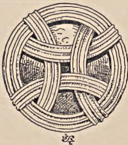
Rys. 2. Różyczka z cegły palonej nad trójliściem odrzwi z kościoła św. Jakóba w Sandomierzu.
