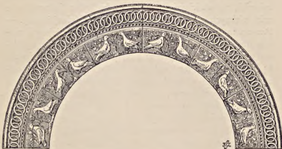
Rys. 22. Cegły w otoku łuku sklepiennego nad oknami nawy z kościoła św. Jakóba w Sandomierzu.
