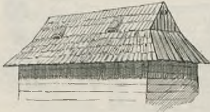
Rys. 15. Dach z dymnikami.
