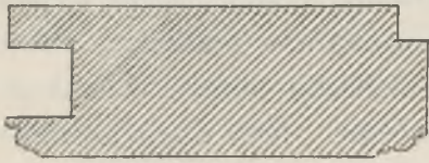
Rys. 4. Przecięcie poprzeczne słupca drzwi lub okna.
