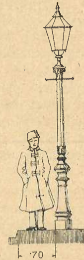
Rys. 32. Ustawienie słupa względem krawężnika.
