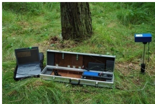
Rysunek 3.8. Pomiar podatności magnetycznej w profilu glebowym miernikiem SM-400 (powierzchnia pomiarowa Szczyrkowice )
