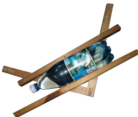
Rys. 5.9 Butelka napełniona wodą na platformie obrotowej
