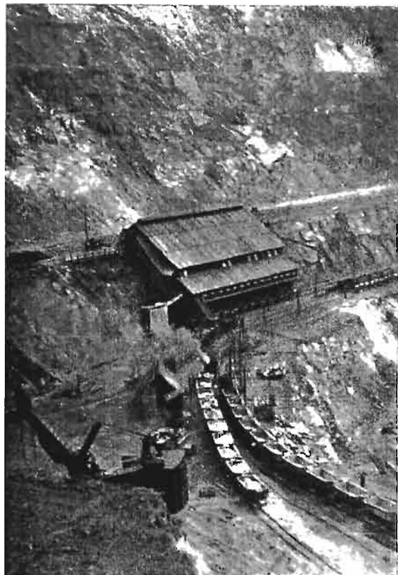
Ryc. 4. Odbudowa odkrywkowa syderytu na Erzbergu. Sortownia.
