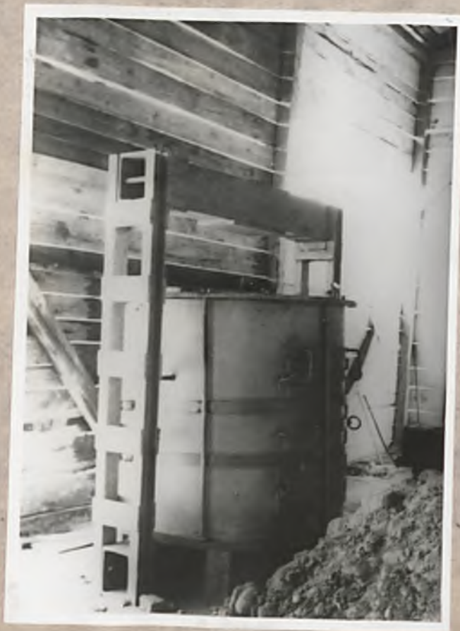
Rys. 9.21. SCHEMAT EDOMETRU WIELKOWYMIAROWEGO (PELNA PLYTA)
