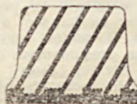
Rys. 32. Trapezowe rowki na obręczy ogumienia pełnego dla wzmocnienia połączenia guma-metal za pomocą ebonitu
