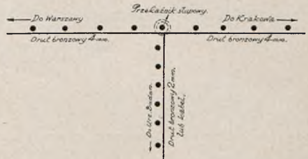
RYS. 2. MIEJSCE ZAINSTALOWANIA PRZEKAŹNIKA.
