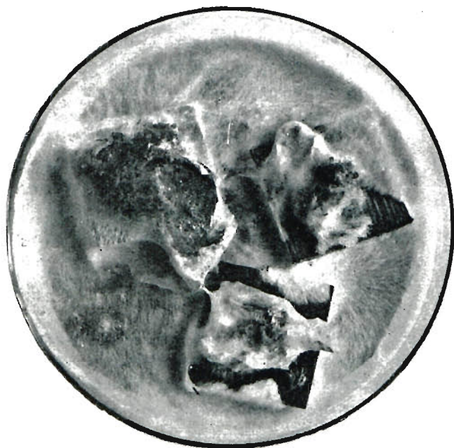
Rycina 2: Typowy obraz niedostatecznego zabezpieczenia grzyb atakuje drewno zaimpregnowane. Image typique de l'impregnation insuffisante, le champignon attaque le bois.
