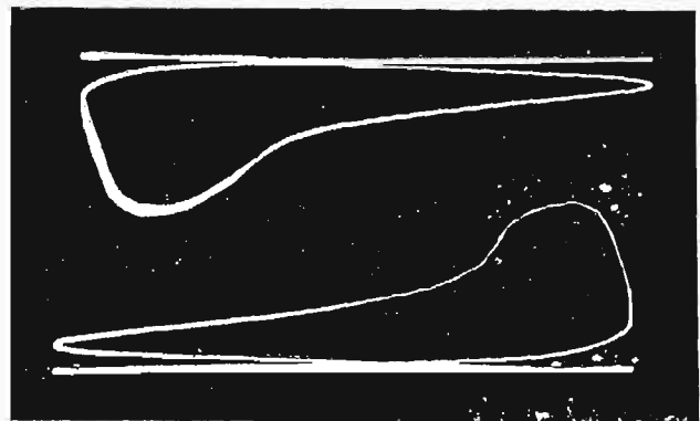
Rys. 1. Wykres ind. silnika Renault, zasilanego mieszanką spirytusową, przy pozostawieniu zapłonu, jak do benzyny.
