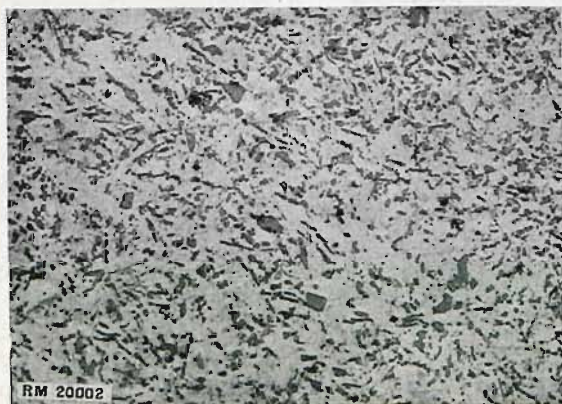
Fig. 16. — Alliage à 13 % de silicium non affiné, coulé en coquille. Après polissage. Gr=200.
