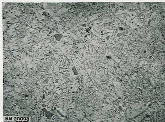
Fig. 17. — Alliage à 13 % de silicium affiné par du tétrachlorure de titane et coulé en coquille. Après polissage. Gr=200.
