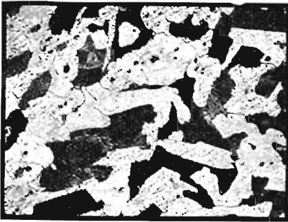
Fig. 89. Acier à 0,4% de C recuit. Ferrite claire sur fond de perlite. Gr. = 130.
