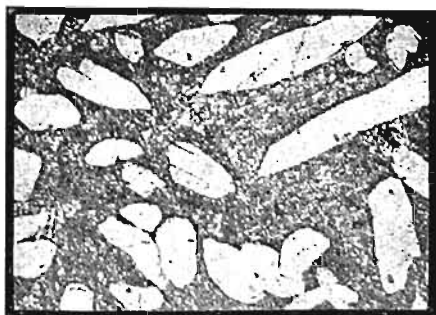
Fig. 45. Bronze d'aluminium à 9% d'Al après recuit. Grains clairs de solution solide limite (7% d'Al) sur fond d'un mélange très fin produit par la décomposition du composé Cu^3Al . Gr.=300. A gauche microphotographie, à droite dessin à la plume.
