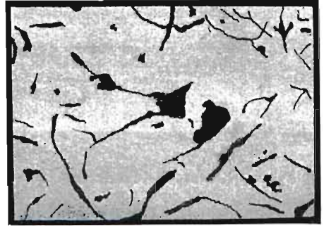
Fig. 19. Fonte grise non attaquée. Lamelles noires de graphite sur fond de métal. Gr. = 250. A gauche, microphotographie, à droite, dessin.
