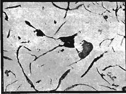
Fig. 19. Fonte grise non attaquée. Lamelles noires de graphite sur fond de métal. Gr. = 250. A gauche, microphotographie, à droite, dessin.
