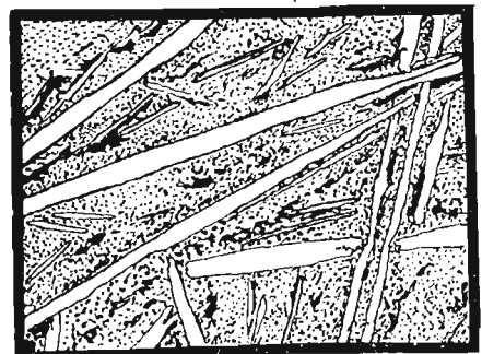
Fig. 10. Fonte blanche hypereutectique. Cristaux clairs de cémentite sur fond d'eutectique (ledeburite). Gr. = 40. A gauche microphotographie, à droite, dessin à la plume.
