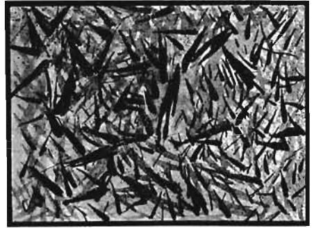
Fig. 55. L'échantillon précédent après trempe. Structure martensitique. Gr.=600. A gauche microphotographie, à droite dessin à l'encre de Chine.
