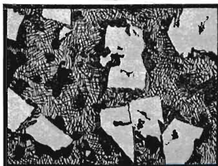
Fig. 18. Alliage antifricition, contenant 80% Pb; 15% Sb; 5% Sn. Cristaux clairs d'antimoine sur fond d'eutectique binaire plomb-antimoine, sombre et d'eutectique ternaire gris. Gr. = 80. A gauche photographie, à droite, dessin.
