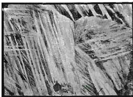
Fig. 50. L'échantillon précédent après trempe. Cristaux et grains de solution solide. Gr.=300. A gauche microphotographie, à droite dessin à l'encre de Chine.
