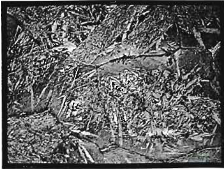
Fig. 127. Acier à 1,5% C trempé. Attaque à l'acide azotique. Cristaux clairs de martensite sur fond d'austénite. Gr. = 300.
