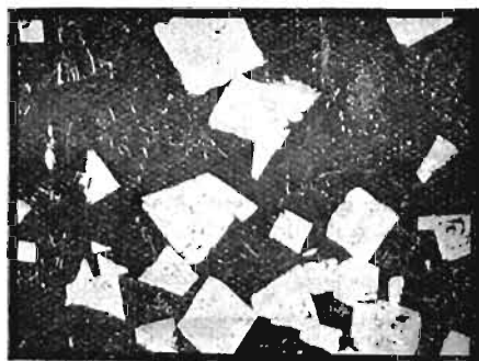
Fig. 17. Alliage contenant 80% Sn, 20% Sb. Cristaux clairs de solution solide d'antimoine dans \text{Sn}_3\text{Sb}_2 (environ 50% Sb) sur fond de solution solide à 9% d'antimoine. Gr. = 80. A gauche, microphotographie, à droite dessin.
