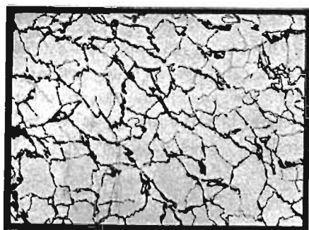
Fig. 28. L'échantillon précédent attaqué au picrate de soude. Cristaux sombres de cémentite sur fond de perlite. Gr. = 125.
