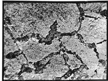
Fig. 90. L'échantillon précédent après trempe à l'huile. Troostite sombre sur fond de martensite. Gr. = 130.
