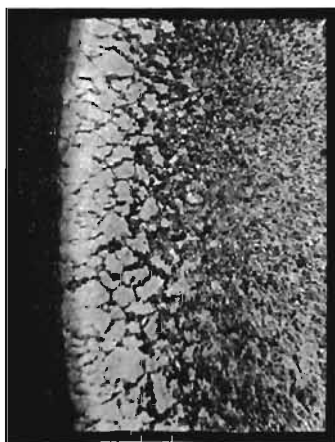
Fig. 123. Fil de fer cémenté lentement. On y voit les couches successives: cémentite sur fond de perlite, perlite pure, ferrite à grain fin sur fond de perlite. Gr. = 50.
