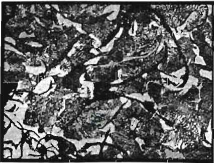
Fig. 20. Le même échantillon après attaque à l'acide picrique. Lames de graphite noir sur fond de ferrite claire et de perlite grise. Gr. = 250. A gauche, microphotographie, à droite, dessin.
