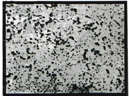
Fig. 128. Acier à 1,5% C refroidi très lentement. A gauche, l'attaque à l'acide picrique montre les cristaux clairs de cémentite globulaire sur fond de ferrite. A droite, l'attaque au picrate de soude montre les cristaux sombres de cémentite sur fond de ferrite. Gr. = 300.
