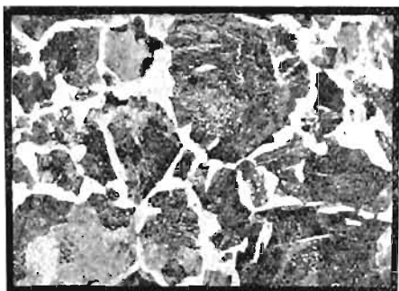
Fig. 116. Acier recuit à 0,6% de C. A gauche, attaque à l'acide picrique. Grain clair de ferrite sur fond de perlite. A droite attaque au réactif de Stead. Grain de ferrite sombre sur fond de perlite claire. Gr. = 70.
