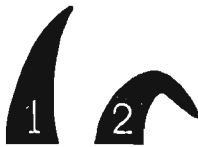
Fig. 79. Affaissement des montres de Seger.
